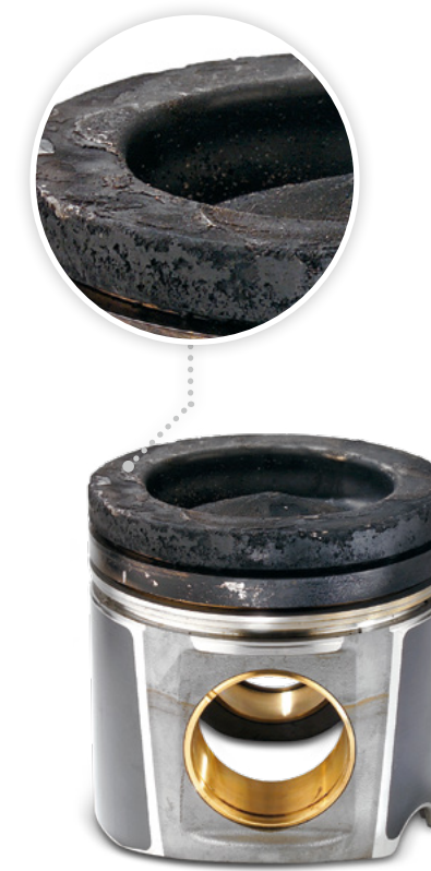
Fig. 3: Capa carbonizada de aceite en la pared de fuego
