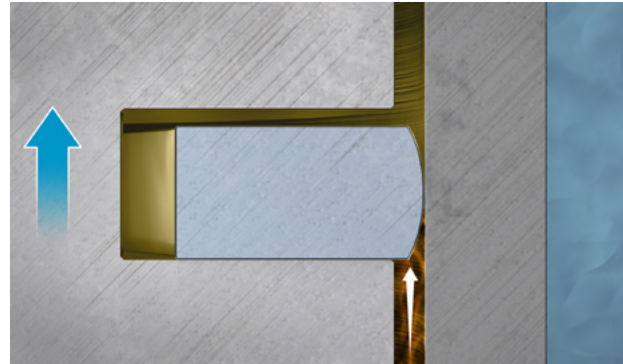
Fig. 1: Estanqueizado mediante el flanco de ranura
