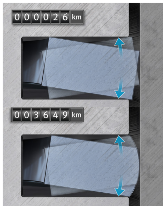
Fig. 1: Abombamiento debido al desgaste de rodaje
