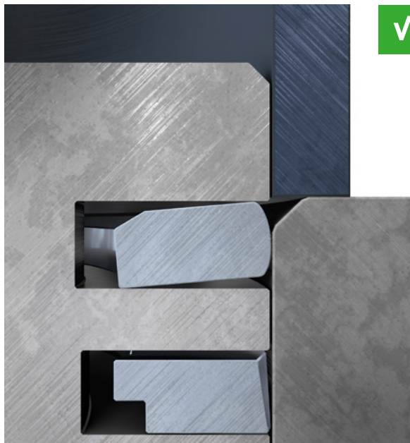
Fig. 2: Chaflán pequeño en el calibre del cilindro: el segmento de pistón se desliza por el intersticio
