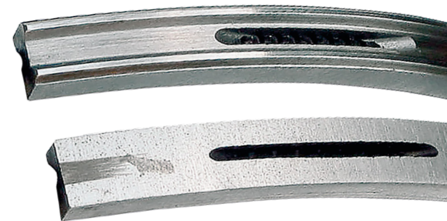
Fig. 3: Segmentos rascadores de aceite nuevo y desgastado
