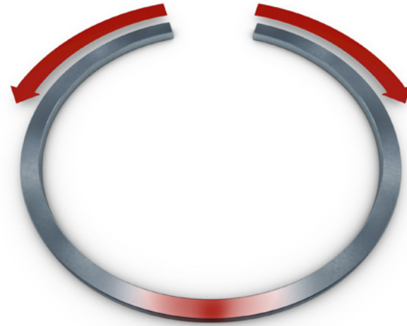
Fig. 1: Apertura excesiva del segmento de pistón
