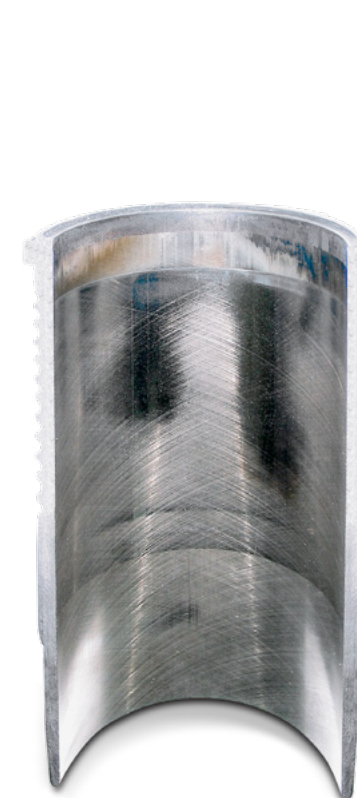
Fig. 2: Puntos brillantes y pulidos en la zona superior del cilindro
