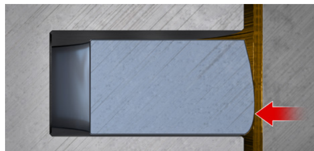
Fig. 3: Superficie de deslizamiento del segmento abombada asimétrica
