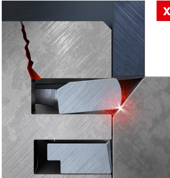
Fig. 1: Chaflán demasiado grande en el calibre del cilindro: el segmento de pistón rebota durante el montaje entre la cinta de sujeción de segmentos de pistón y el cilindro y el pistón se bloquea
