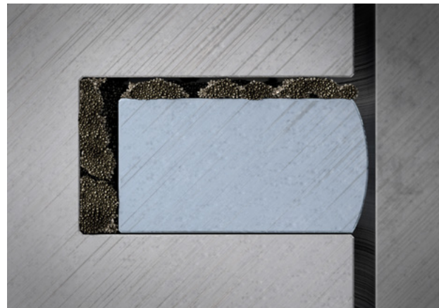
Fig. 1: Sedimentos de suciedad en la ranura para segmentos
