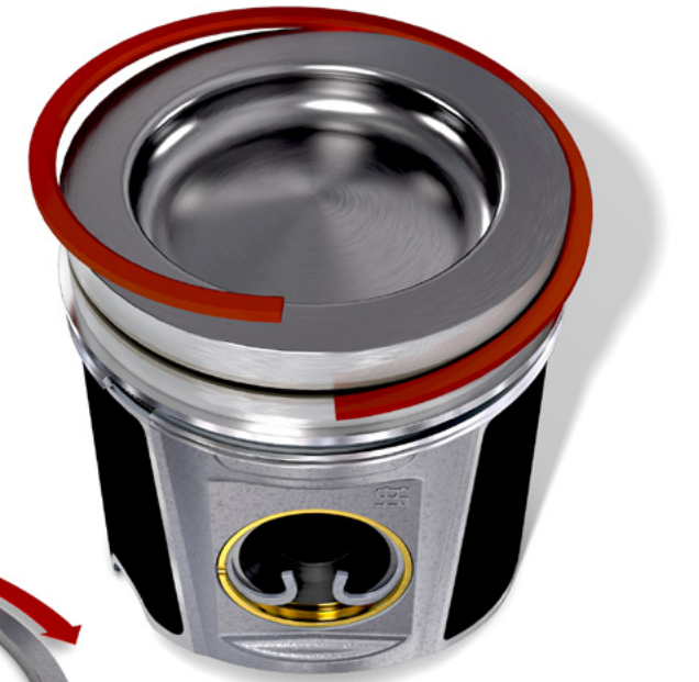
Fig. 1: Retorcimiento y expansión de los segmentos al montarlos en el pistón
