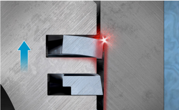
Fig. 3: Golpeo del segmento de pistón en un pistón nuevo
