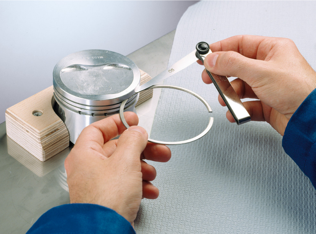
Fig. 1: Medición de la holgura vertical de los segmentos
