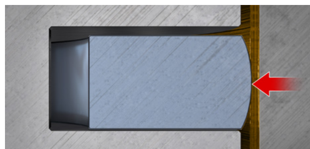
Fig. 2: Superficie de deslizamiento del segmento abombada simétrica
